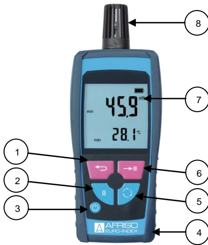
Rys. 1. Wygląd i budowa miernika temperatury i wilgotności na przykładzie modelu FT30
