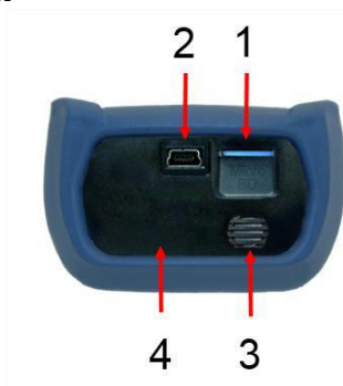
Rys. 4. Schemat położenia interfejsów oraz głośnika w dolnej części obudowy
