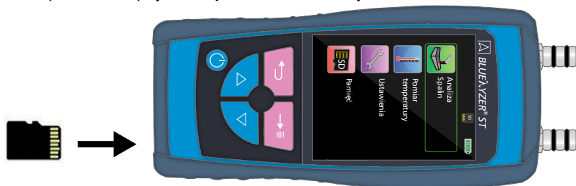
Rys. 8. Prawidłowa instalacja karty MicroSD w gnieździe analizatora spalin
