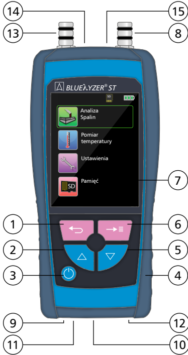
Rys. 1. Wygląd i budowa analizatora spalin BLUEZYZER ST
